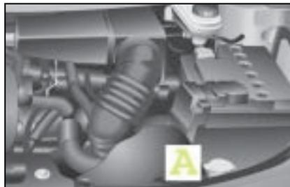
Abertura para líquido de refrigeração no motor a gasolina e BRABUS
