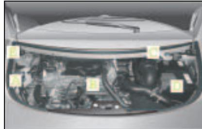
Compartimento do motor em motores diesel
