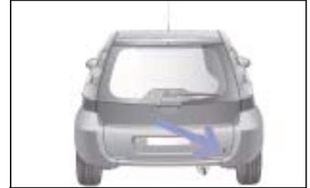
I punti di fissaggio sul lato posteriore servono a trainare altre vetture.
