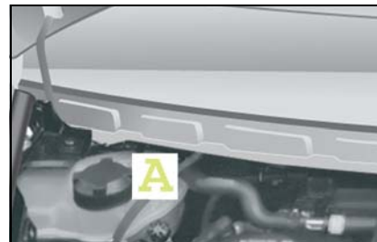
Ouverture de remplissage du moteur diesel
